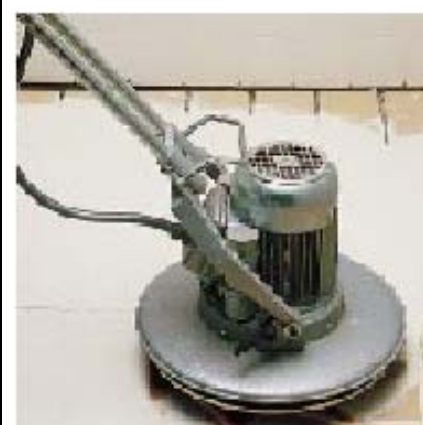
Нанесение с помощью затирочной машины
